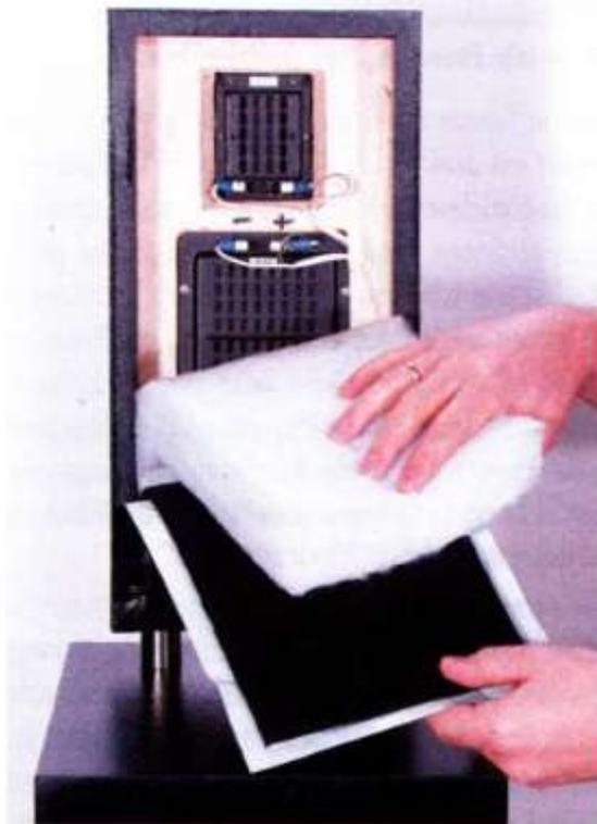
Das Mitteltongehäuse besitzt statt einer Rückwand einen akustischen Fließwiderstand. Dieser besteht aus sehr schwerem Polyestervlies (hell) sowie einem dünnen Spezialvlies (schwarz). Die Befestigung mit Gewebe-Klebeband ist nur ein Vorschlag: Hierfür lässt sich sicher auch eine solidere Lösung finden.
