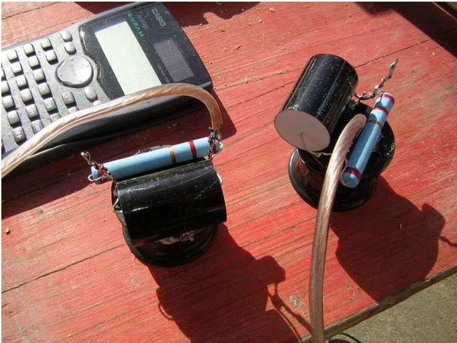
Ich hab die Teile wie dargestellt auf der Luftspule angeordnet (zusätzlich mit Heißkleber gesichert), die Drähte dann so gut es ging verdrillt und mit ordentlich Lötzinn verlötet. Durch das Loch in der Mitte der Spule konnte man das Paket dann irgendwo anschrauben (in dem Fall im Hohlraum unter E an der Seitenwand). Wenn du Teile mit Abstand zueinander anordnen willst würde ich ganz normales LS Kabel mit 1.5-2.5mm<sup>2</sup> Querschnitt nehmen.
